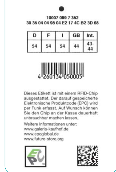
Abb. 2: Beispiel eines Bekleidungsetiketts mit dem GS1 DataMatrix als Back-Up-Datenträger für einen EPC-Transponder.
